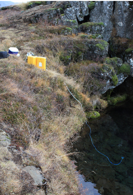
2. mynd. Vinstri myndin sýnir sýnatöku í Silfru á Þingvöllum. Söfnunarslanga var látin síga á nokkurt dýpi í vatnið og vatni dælt beint í gegn um síunarbúnað í söfnunarflöskur. Hægri myndin er af Vellankötlu þar sem hún streymir upp í Vatnsvíki – Figure to the left shows water sampling in Silfra at Þingvellir. The water was pumped directly from the spring through a filter into sampling bottles. Figure to the right shows the upwelling of Vellankatla in Vatnsvík, just off the NE-bank of Lake Þingvallavatn. Ljósmyndar: Daði Þorbjörnsson.
